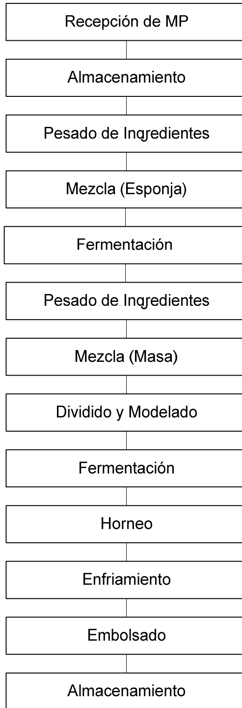
Figura 7. Diagrama de bloques del proceso de fabricación de pan
