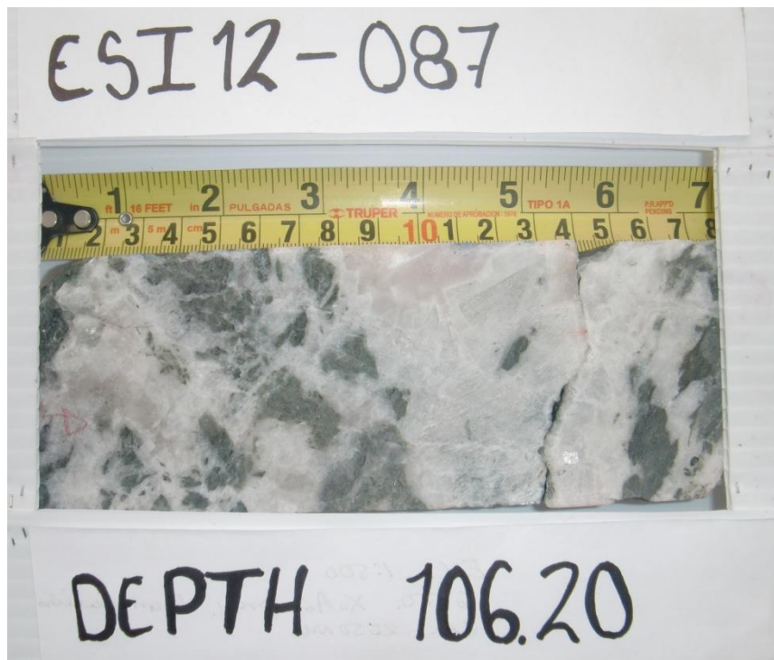
Fig.6 Descripción: Veta Intermedia con textura de brecha en donde los fragmentos angulosos de andesita muestran una ligera foliación, posiblemente una textura fluidal?; se observa calcita, cuarzo blanco y gris de manera brechada como cementante.
