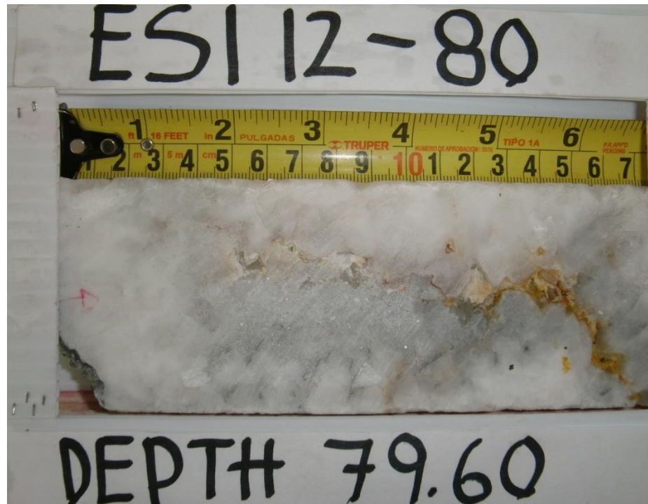
Fig.12 Descripción: Veta Nombre de Dios donde se observa cuarzo blanco de textura colofome, sílice amorfo blanco y gris, calcita de textura masiva, hematita relleno de fracturas, pirita y sulfuros de Ag diseminados.
