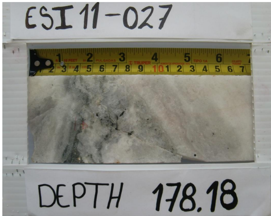
Fig.7 Descripción: Veta Intermedia con calcita masiva y navaja, cuarzo blanco bandeado, sílice amorfo, trazas de pirargirita y pirita diseminada.
