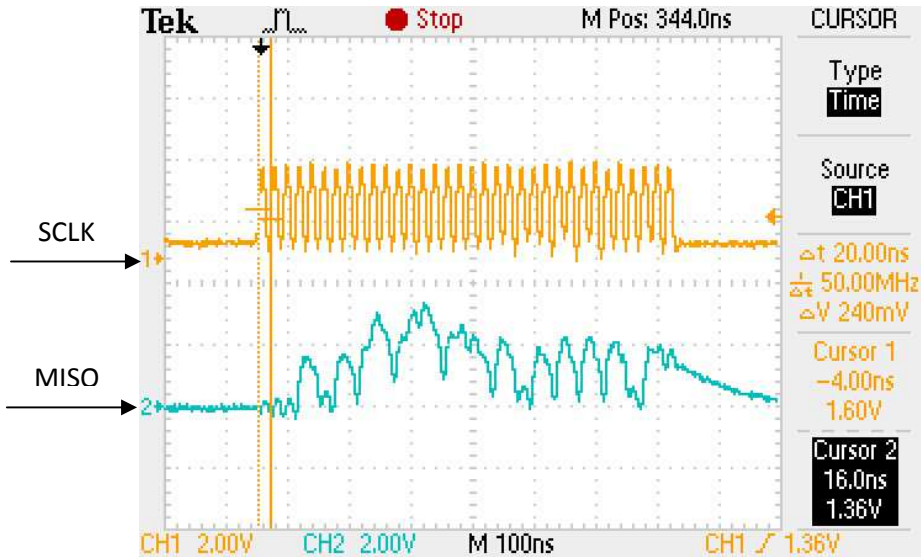
Figura 3.17. Señal SCLK (amarillo) y señal MISO (azul).
