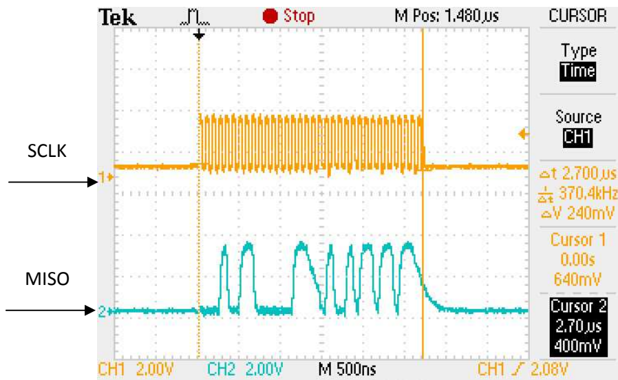
Figura 3.19. Señal SCLK (amarillo) y señal MISO (azul) bien definidas.
