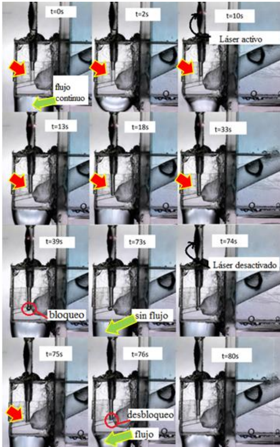
Figura V.16 Secuencia de fotografías que muestra la operación de la válvula de manera activa, cuando un flujo hacia la salida está presente (ver caída de las gotas adheridas en la base). A partir de t=39 s, el flujo es parado por la acción de la válvula opto-neumática.
