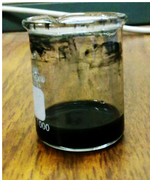
Figura IV.4 Mezcla de PDMS y nano-polvo de carbono para recubrir capilares.
