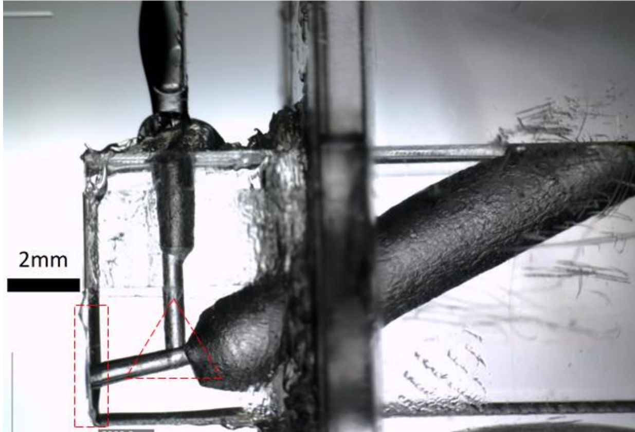
Figura V.13 Fotografía que muestra la estructura central del dispositivo opto-neumático microfluídico. En el lado izquierdo se puede apreciar la interconexión de los tres micro canales (triángulo punteado); dos de ellos con reducciones (microdiodos) para incrementar la presión y enfatizar el flujo del líquido en una única dirección. No es posible distinguir la membrana flexible de PDMS (rectángulo punteado), sumamente delgada, colocada en la cara frontal del cuerpo rectangular de acrílico a la salida. Del lado derecho (dentro de la cubeta) el canal de mayor diámetro se comunica con el depósito abierto al ambiente.
