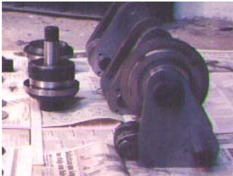
Fig. 4.10 Soporte de rodillos y chumacera
