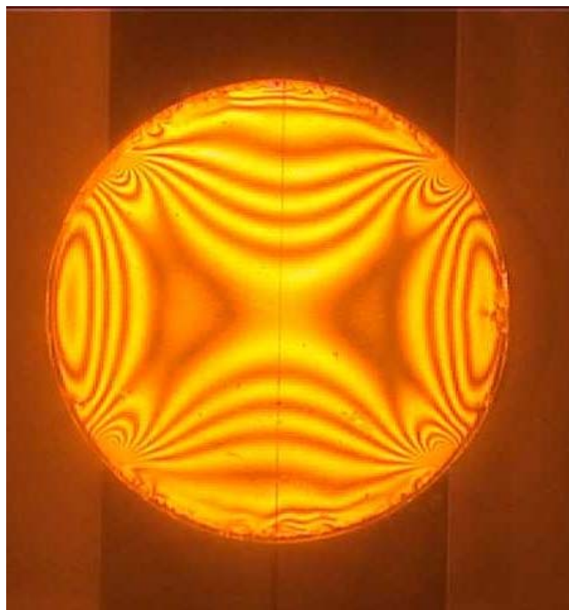
Fig. 3.11 Líneas de deformación constante producidas por dos indentadores cilíndricos y opuestos sobre un cuerpo elástico
