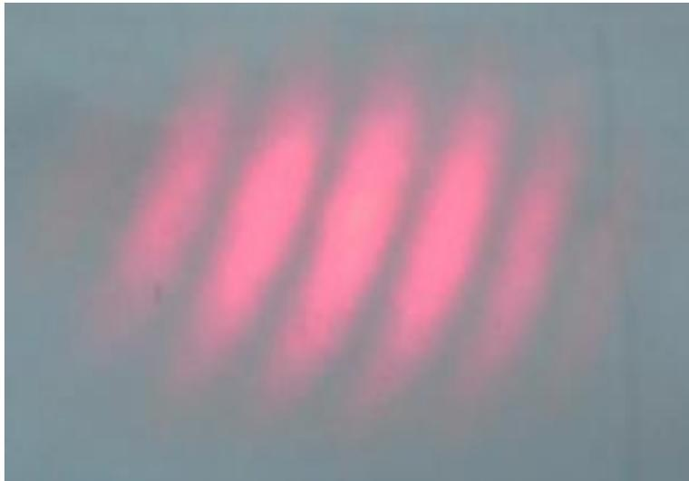
Figura 3.24. Imagen de las franjas de interferencia proyectadas en una superficie plana.
