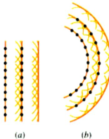
Figura 1.3. Principio de Huygens, para la propagación derecha de una (a) onda plana y una (b) onda esférica.
