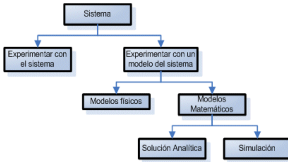
Figura 1.1 Alternativas para el estudio de un sistema [1]
