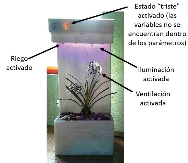
FIGURA VI.23 VISUALIZACIÓN DEL DISPOSITIVO CAREPLANT EN FUNCIONAMIENTO
