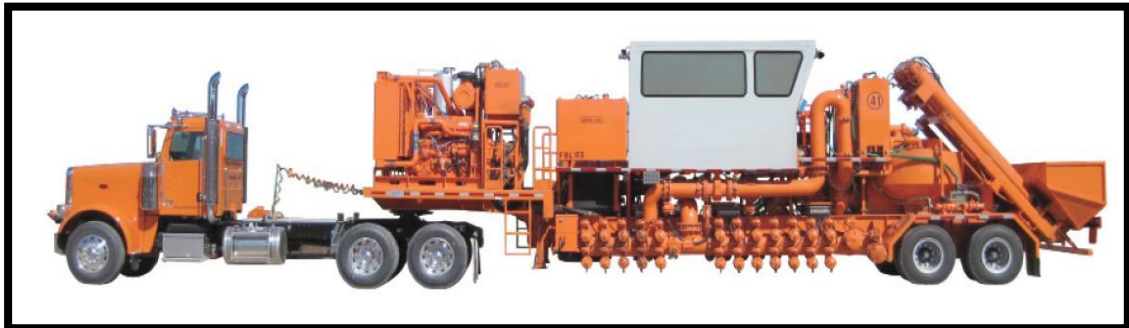
Figura 2.2-B. Mezclador de productos químicos y apuntalante (Blender). 8
