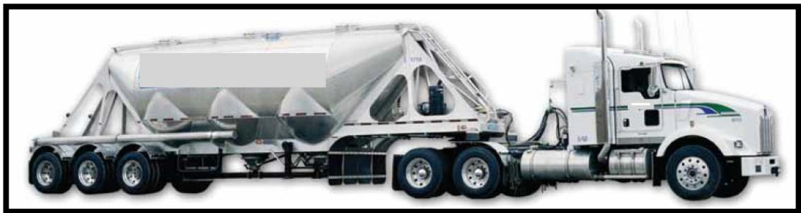
Figura 2.2-C. Tráiler de transporte de apuntalante. 4
