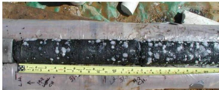
**Figura 2.1.1.** Medición de un núcleo que tiene capas de carbón (Fuente: CSUR en Alberta, 2013).
