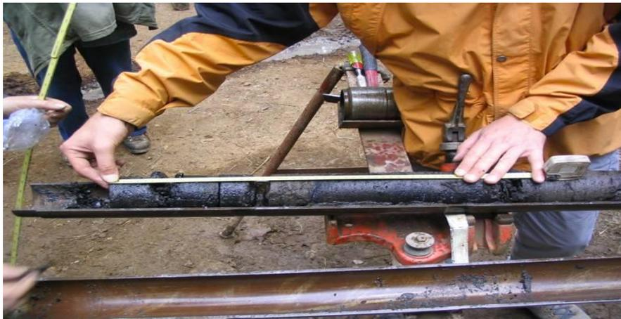
**Figura 2.1.2. Otro ejemplo en la medición de un núcleo que tiene capas de carbón (Fuente: CSUR en Alberta, 2013).**
