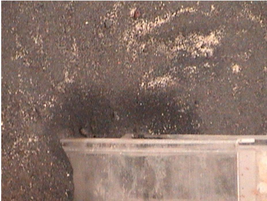
Figura 6.8 Erosión generada después del *flushing* en el modelo físico para  $t=17$  min.
