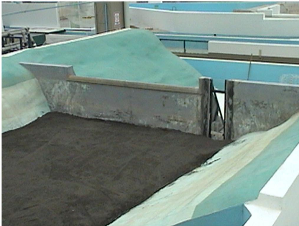
Figura 5.6. Embalse y cortina del modelo físico visto hacia aguas abajo.
