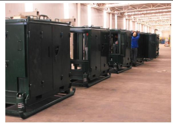
*b) Acabado con pintura electrostática parte exterior de la estructura.*
