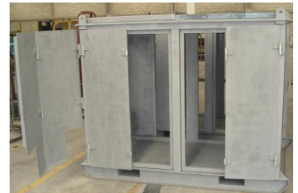
*b) Acabado del proceso del arenado a la parte exterior de la estructura y a las puertas abatibles.*
