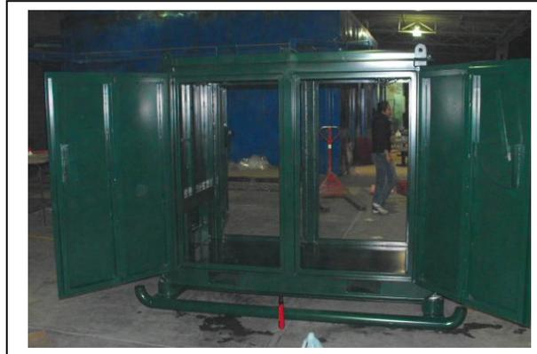
*a) Acabado con pintura electrostática parte interior de la estructura.*
