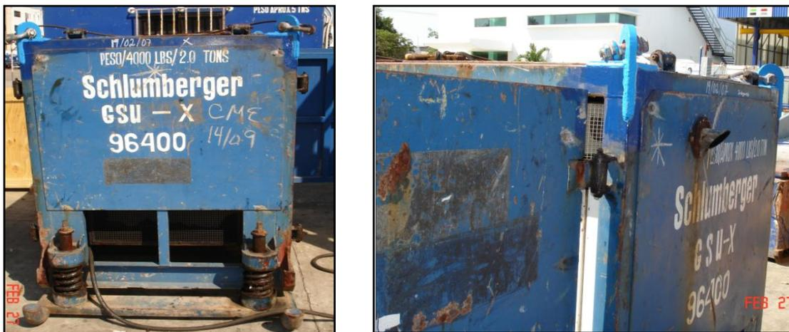
Figura 3.4. La estructura no se encuentra totalmente cerrada, exponiendo a la intemperie parte del Generador, también no cuenta con puertas laterales, dificultando la ventilación del motor del generador. Personal operario recomendó emplear el mismo sistema de amortiguación.
