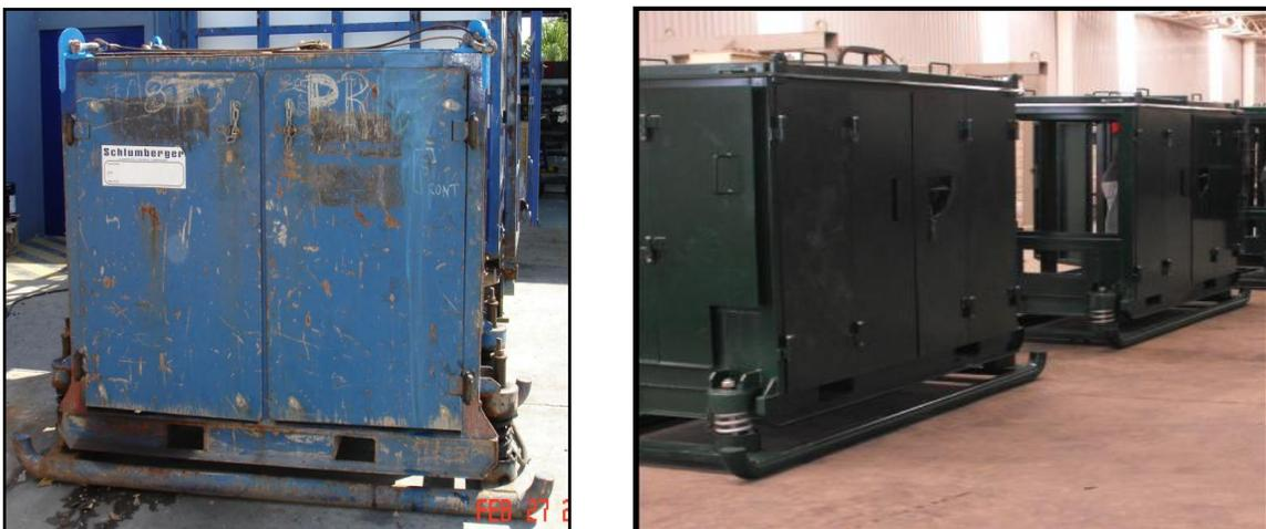
*Figura 5.1. Caja para transportar el Generador Lister usada anteriormente y rediseño terminado.*
