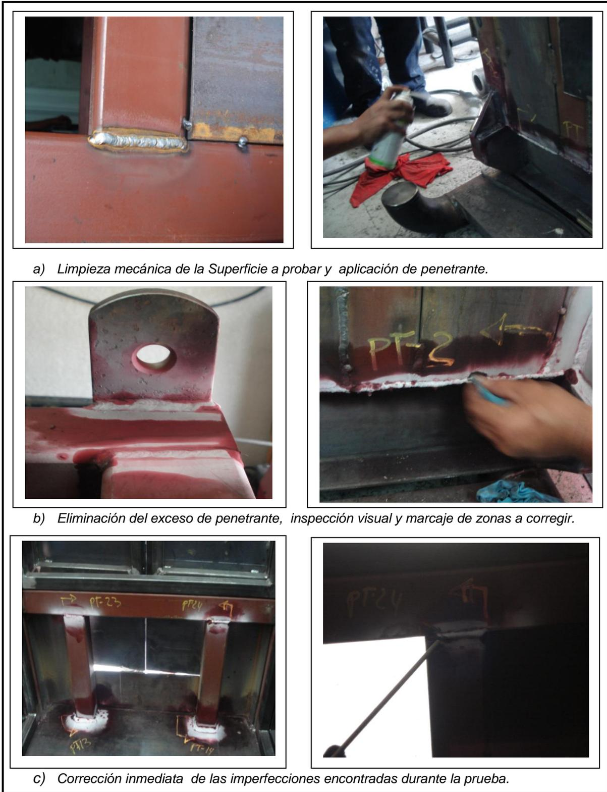
Figura 3.50. Evaluación de las uniones soldadas en la estructura base por medio de la prueba de líquidos penetrantes.
