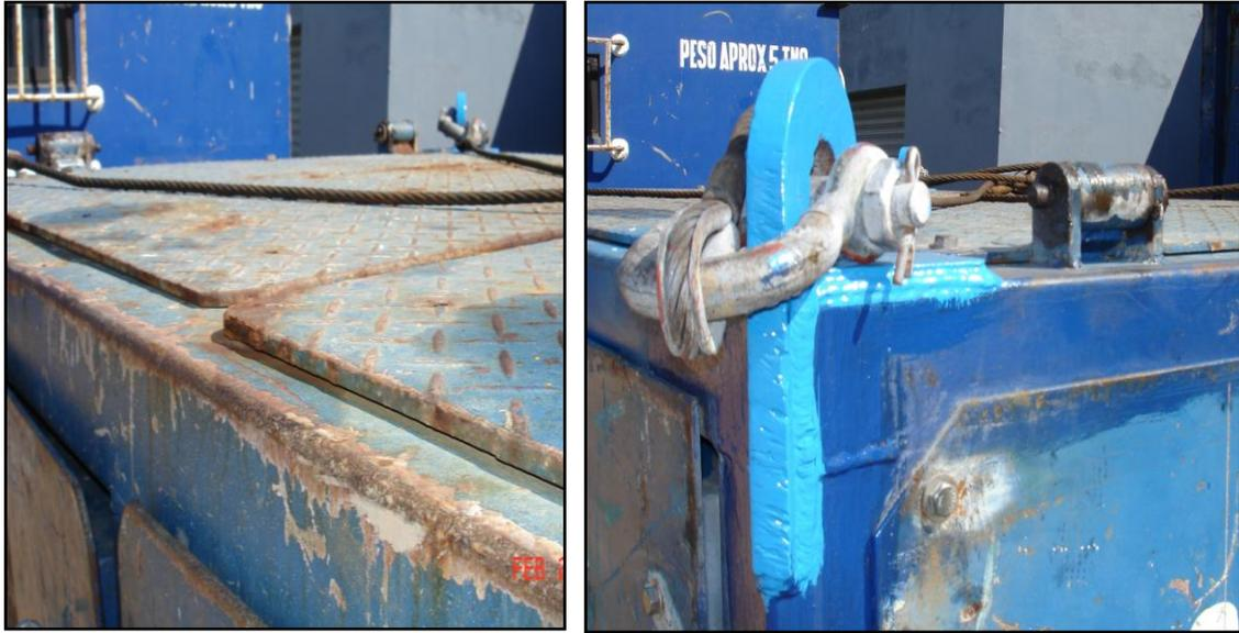
Figura 3.3. Las puertas superiores son de placa antiderrapante de 1/4" de espesor, sin tope en la estructura para evitar la entrada de la lluvia; Los cáncamos de izaje originales fueron cambiados por otros con un espesor de 3/4".
