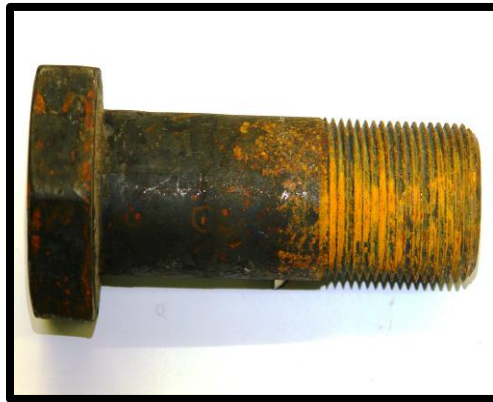
Fig.2.11: Ejemplo de corrosión en elemento mecánico [UDIATEM].
