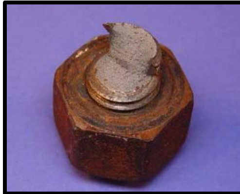
Fig.2.9: Fractura frágil flexión en tornillo [IDDP].
