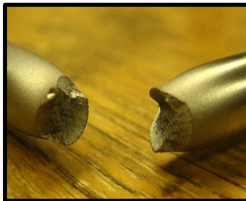
Fig.2.4: Ejemplo de fractura dúctil [IDDP].
