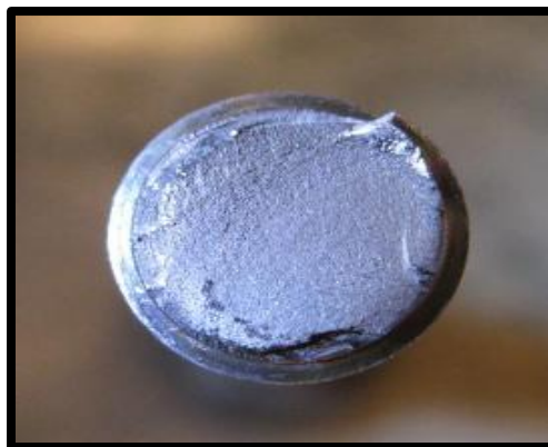
Fig.2.8: Fractura frágil a tensión en tornillo [IDDP].
