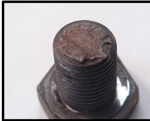
Fig.2.23: Falla por fractura por fatiga a tensión [UDIATEM].
