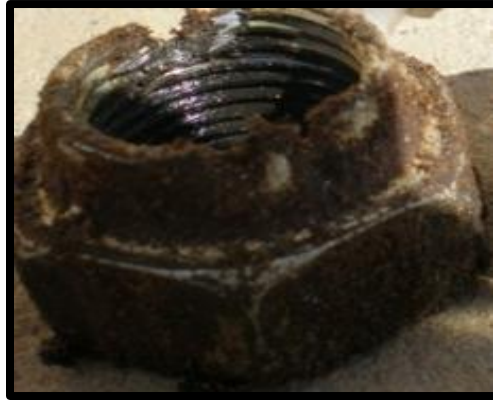
Fig.2.20: Barrido en tuerca de tornillo [IDDP].
