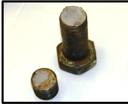
Fig.2.7: Ejemplo de fractura frágil [UDIATEM].
