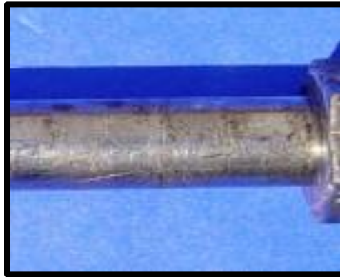
Fig.2.15: Falla por ludimiento en tornillos [IDDP].
