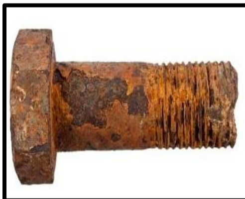
Fig.2.13: Falla por corrosión uniforme en tornillo [IDDP].
