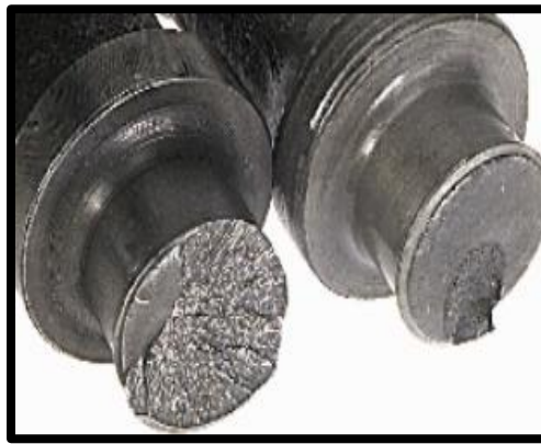
Fig.2.21: Ejemplo de fractura por fatiga [IDDP].
