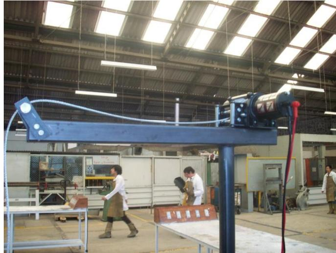
Figura 7.4 Malacate eléctrico montado en el prototipo 2.
