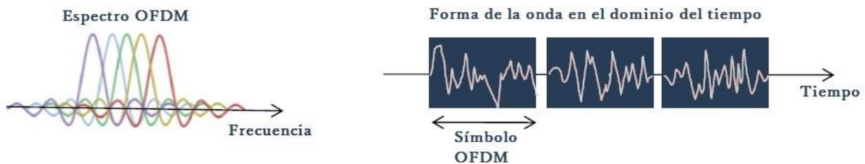
Figura 2. 6 Espectro OFDM (derecha) y Forma de la onda en el dominio del tiempo (izquierda) [18].
