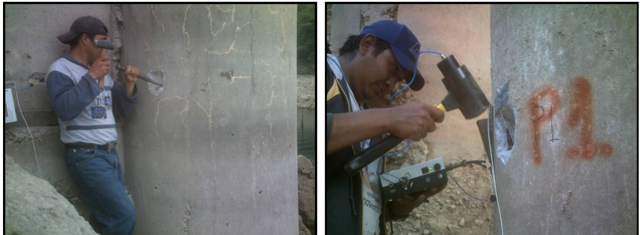
Figura 13. (a) Elaboración de nichos y (b) momento en que se produce un impulso sísmico por medio un golpe de marro.
