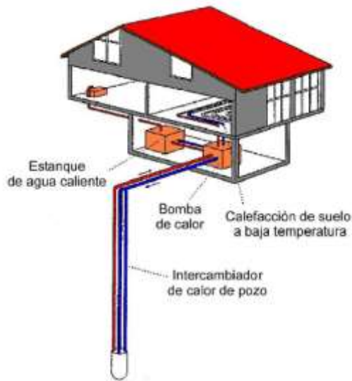
Figura 1.6. Bomba de calor geotérmica para calefacción doméstica. (Mary H. Dickson & Mario Fanelli, 2012)
