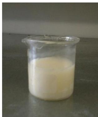
**Fig. 2.4** Solución 3: recubrimiento híbrido Sol Gel.
