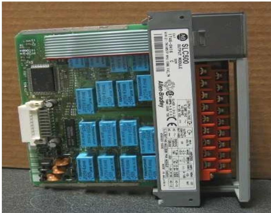
MODULO DE SALIDAS
