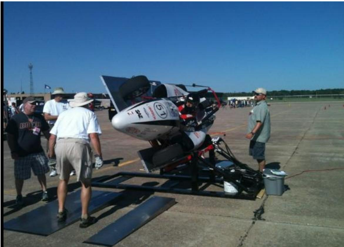
Imagen II-1: Prueba de Inclinación: Equipo UNAM Motorsports, Nebraska 2012
