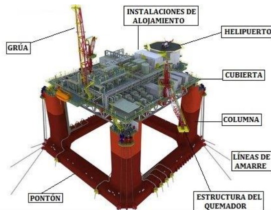
FIGURA 6.6, "PRINCIPALES COMPONENTES DE UNA SEMI-SUMERGIBLE"
