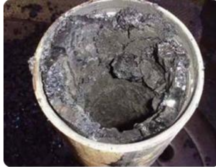
FUENTE: www.janusenergyresources.com/asphaltene-inhibitors.html FIGURA 5.6 “DEPOSITACIÓN DE ASFALTENOS DENTRO DE LA TUBERÍA”
