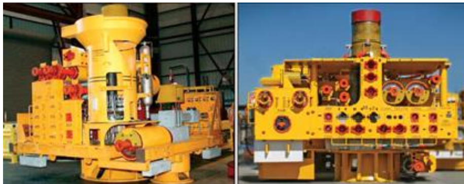
FUENTE: FMC Technologies Inc FIGURA 3.7, "VXT (IZQUIERDA) Y HXT (DERECHA)"
