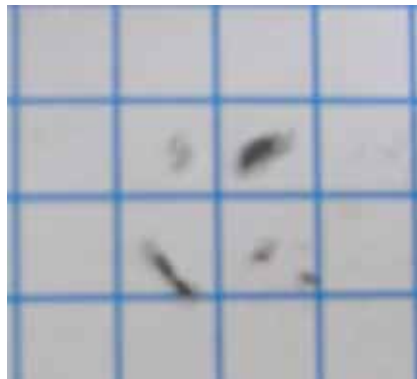
Fotografía 7.13 Partículas acumuladas en el reten del cojinete
