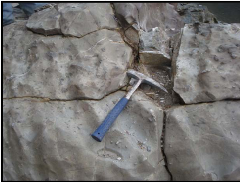
Fotografía 4.6. Detalle del afloramiento de metaconglomerado de la formación Acapetlahuaya ubicado en margen derecha del río balsas en la zona de boquilla.
