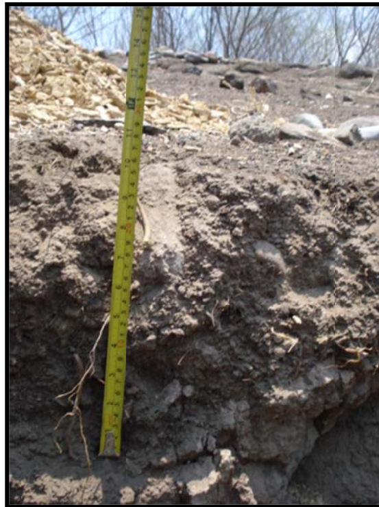
Fotografía 4.11. Capa de suelo de color gris oscuro de apenas 0,27 m de espesor, derivado del intemperismo de la Formación Acapetlahuaya.
