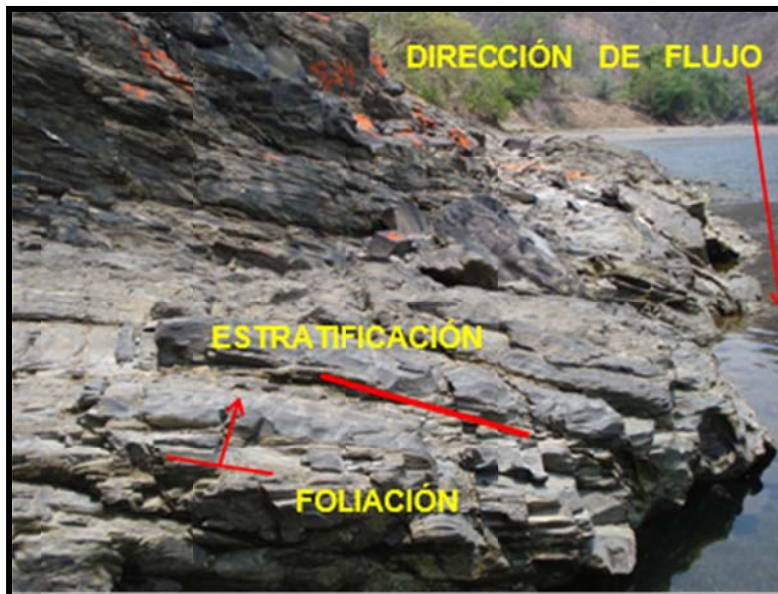
Fotografía 4.21. En la zona del eje de Cortina “GEOL”, sobre la margen derecha, la foliación favorece a la construcción de la obra, debido a que tiene una dirección de inclinación contraria a la dirección de flujo del río.
