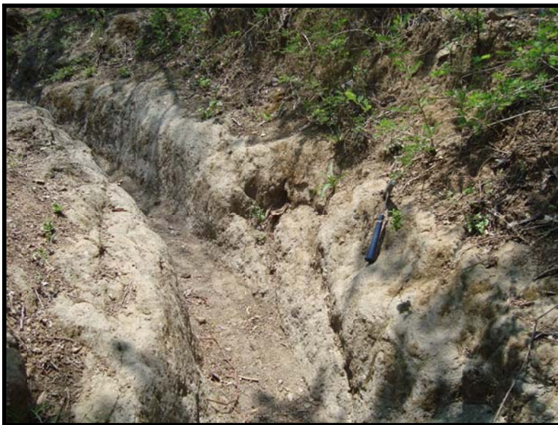
Fotografía 3.8. Horizonte de arena (Qar) que aflora por encima de la terraza aluvial (Qtal) en la zona de embalse.
