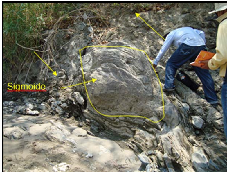
Fotografía 4.12. La falla cruza a la alternativa del eje propuesto “GEOL”, con formación de estructuras de tipo sigmoidal, que determinan un sentido de desplazamiento inverso.
