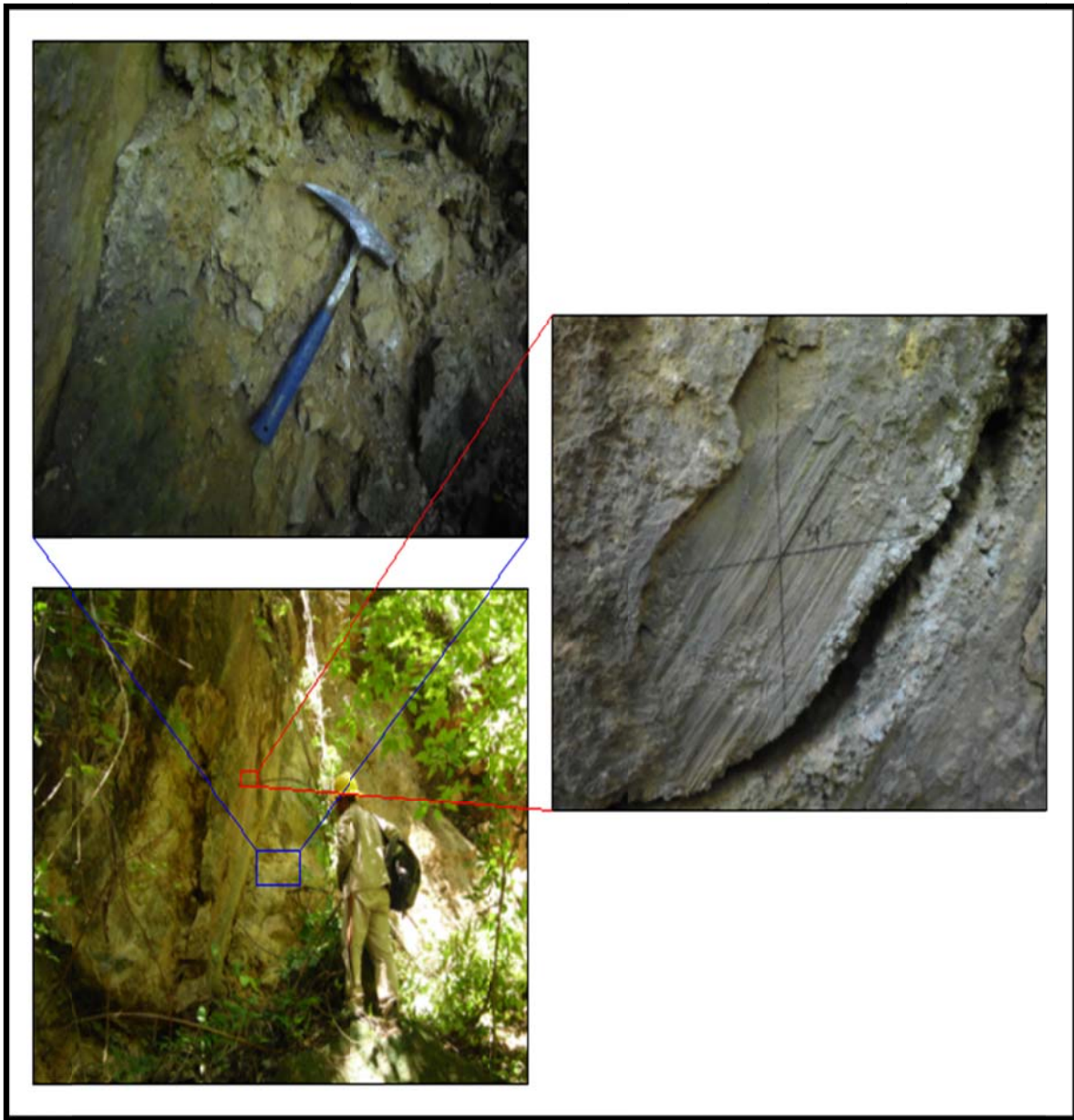
Fotografía 4.17. En la parte inferior izquierda se observa el plano de falla, la zona de material triturado y harina de falla; las dos fotografías superiores son un acercamiento del plano de falla donde se presentan estrías y las características del material arcilloso.
