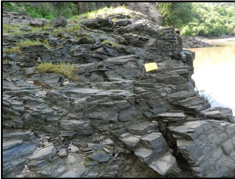
Fotografía 4.2. La metalutita en estado fresco presenta resistencia al golpe del martillo. En la imagen se muestra claramente el desarrollo de los planos de foliación.
