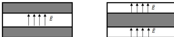
Figura 2.6: Discontinuidades en la guía de onda rectangular que producen una capacitancia en su circuito equivalente.
