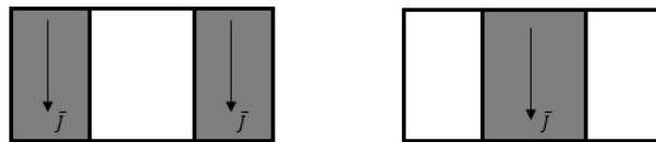
Figura 2.5: Discontinuidades en la guía de onda rectangular que producen una inductancia en su circuito equivalente.
