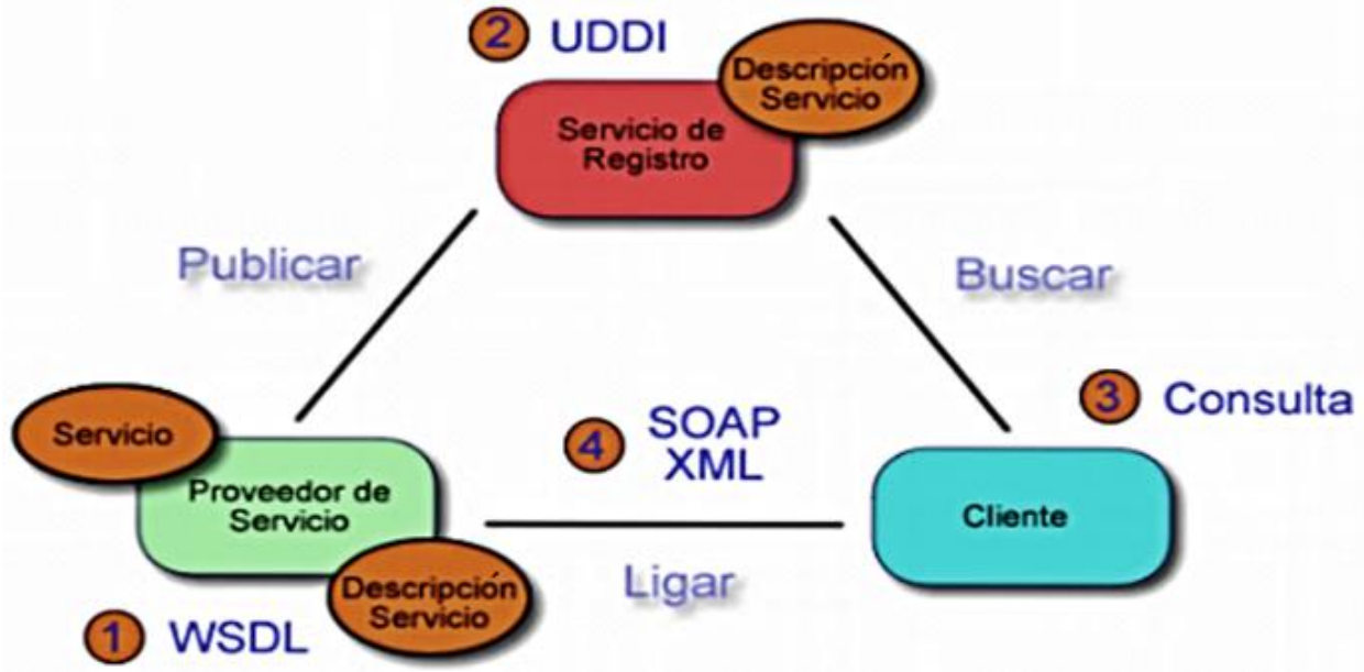
Figura 2.1.2. Topología de un sistema basado en Web Services.
