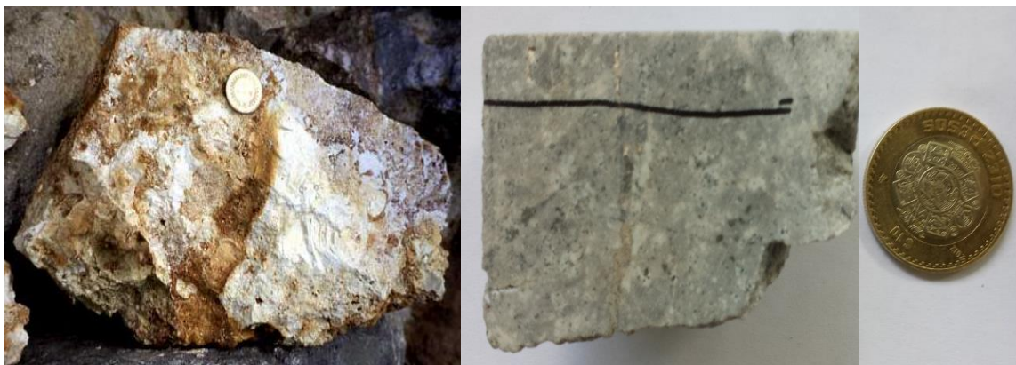
Figura III.10 Izquierda: Alteración argílica avanzada en el distrito Chinkuashih, Taiwán, caracterizado por ser un depósito de Au-Ag-Cu de Alta Sulfuración, tomada de Laznicka (1999). Derecha: Muestra de núcleo del yacimiento La India, Sonora, México, presentando asociación de minerales de alteración argílica avanzada.
