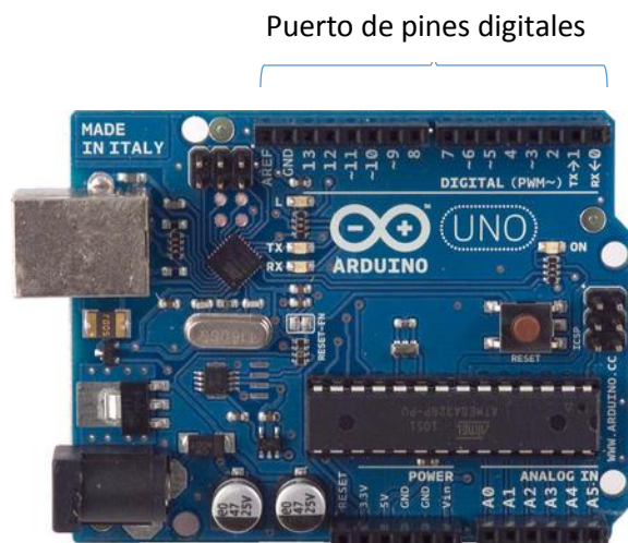
Figura 4.14.- Puerto digital. ArduinoUNO. Sistema de interfaz [32]
