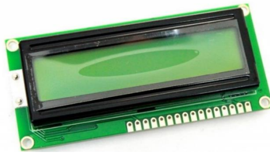
Figura 3.11.- Pantalla LCD de 16x2 [31]
