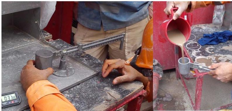
**Fig. 4.p. Prueba de densidad con la balanza Baroid.**
