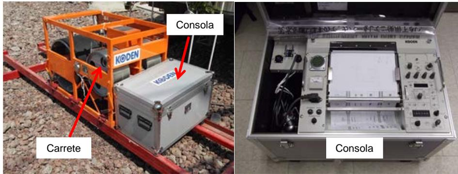
**Fig. 4.b.1. Consola y carrete del KODEN.**
