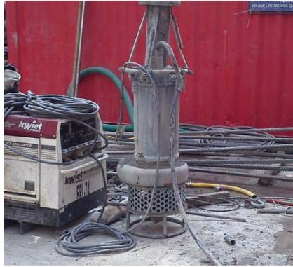
Fig. 4.w. Bomba sumergible para desarenar el lodo bentonítico.
