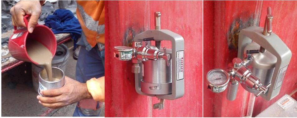
**Fig. 4.q. Prueba de película impermeable (cake).**
