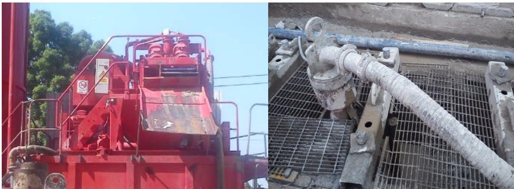
Fig. 4.x. Desarenador tipo Caviem y tubería para la extracción de lodo para su desarenado.
