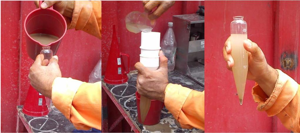
**Fig. 4.s. Prueba de contenido de arenas.**
