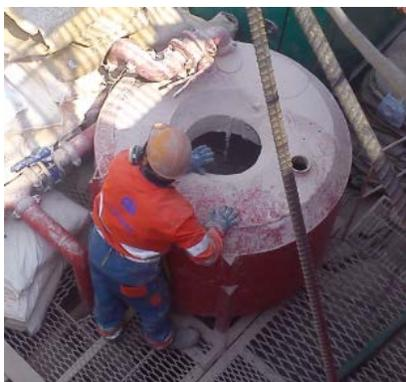
**Fig. 4.t. Tolla para elaborar el lodo bentonítico.**
