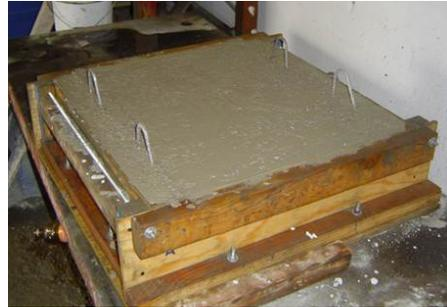
**Figura 3.15 Moldeado y vibrado de especímenes**
