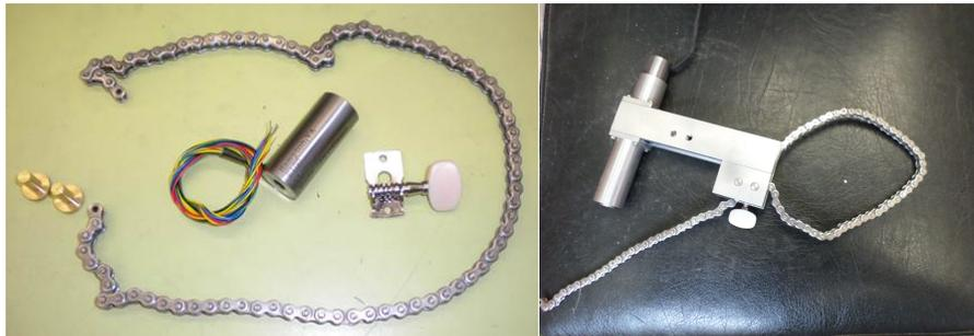
Figura 3.4 Cadena circunferencial y extensómetro ya fabricados
