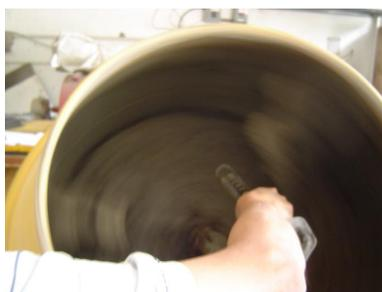
**Figura 3.12 Incorporación de aditivo Pozzolith 322 N**
