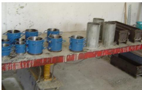
**Figura 3.11 Moldes cilíndricos y prismáticos**
