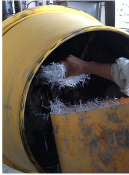
**Figura 3.13 Adición de fibras a la revolvedora**
