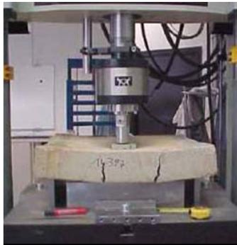
**Figura 1.14 Configuración del panel cuadrado (EFNARC, 1996)**
