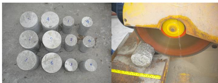
Figura 3.17 Testigos extraídos y procedimiento de corte
