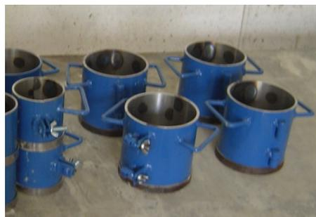
**Figura 3.2 Moldes de 100 y 150 mm**
