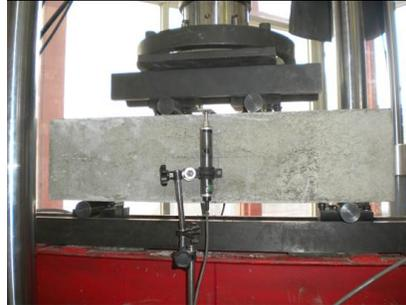
Figura 4.23 Configuración del ensayo de flexión
