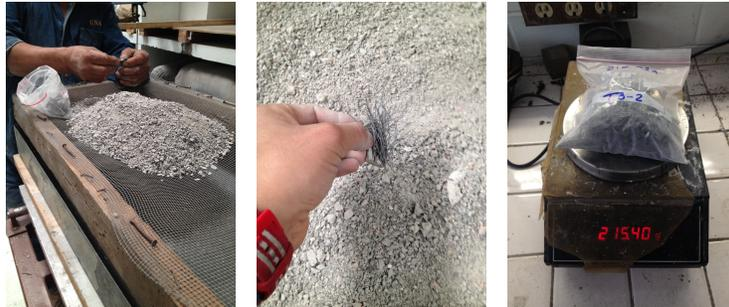
**Figura 3.21 Procedimiento de extracción y pesado de fibras**
