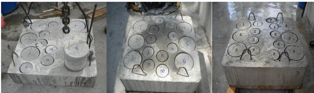
**Figura 4.13** Localización de las probetas testigo
