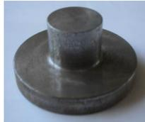
**Figura 3.6 Punzón para probetas de 100 mm de diámetro**
