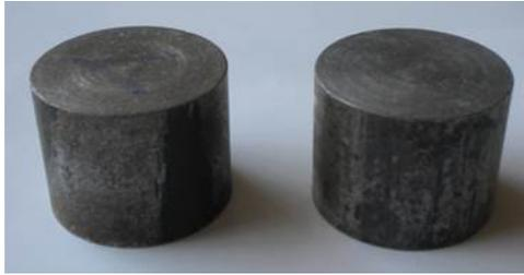
**Figura 3.5 Punzones para probetas de 150 mm de diámetro**
