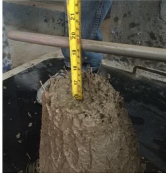
**Figura 3.14 Prueba de revenimiento**
