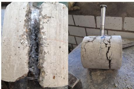
**Figura 3.18** Detalle de fisuración y procedimiento de separación
