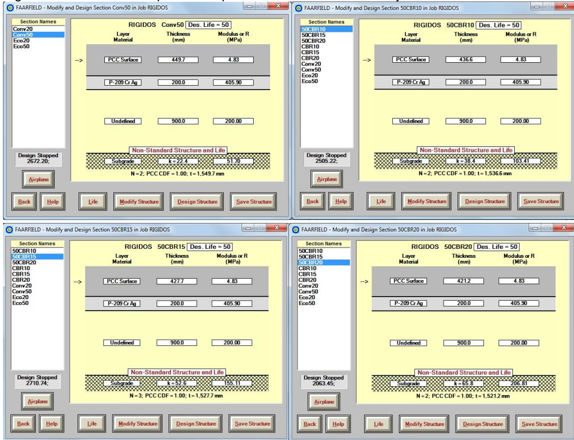
Figura 3.47 Estructura de pavimento para una vida útil de 50 años y k de 22.4 MN/m 3 a 65.8 MN/m 3
