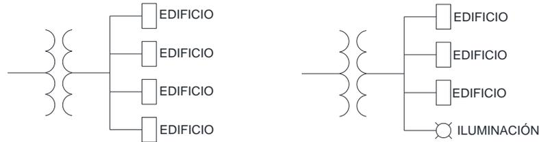
Imagen 6.15. Alimentación a edificios e iluminación exterior.
