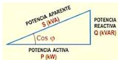
Imagen 2.1. Triángulo de Potencia
