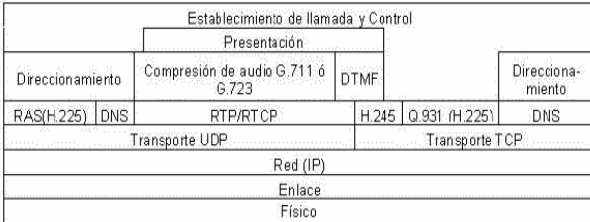
Figura 25 Trama de protocolo
