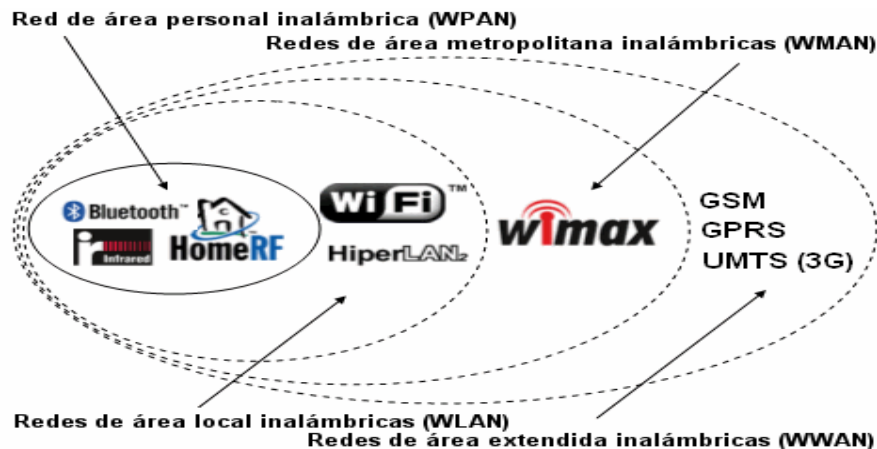
Figura 10 Modelo redes WLAN y WPAN.
