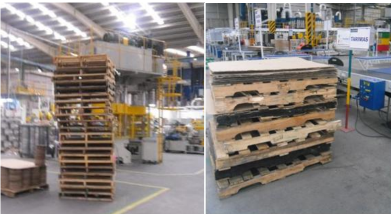
Figura 14. Comparativa de la situación de almacenamiento anterior al uso de límites kanban y la situación de almacenamiento con el uso de límite kanban
