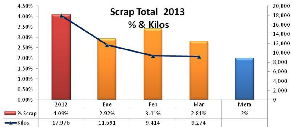
Gráfica 10. Kilogramos de SCRAP y porcentaje de SCRAP con respecto a los kilogramos fabricados semana 13, 2013.
