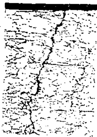
FIG. 202 x 150 Grieta transcristalina en un acero al Cr-Ni 118-8 + 3% 500s despues de 14 dias en cloruro de etilo (Por cortesía de Hodze y Miller)
