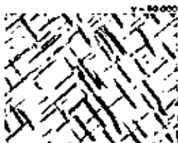
Al-Cu (4,8 Gew.-% Cu, 0,01 Gew.-% Cr): Sekundärphase in Matrixphase (Al 2 Cu, Al 3 Cr)
