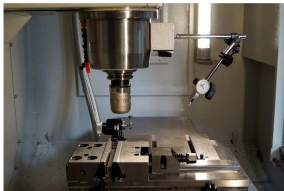
Figura 3.7 Conjunto base magnética-articulación-indicador de carátula
