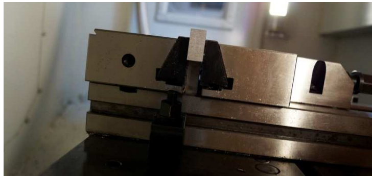
Figura 3.13 Mayor contacto posible entre mordazas y probeta
