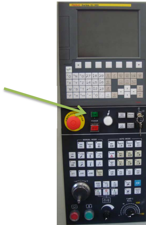
Figura 5. Se muestra la ubicación del botón de encendido en el panel de control.
