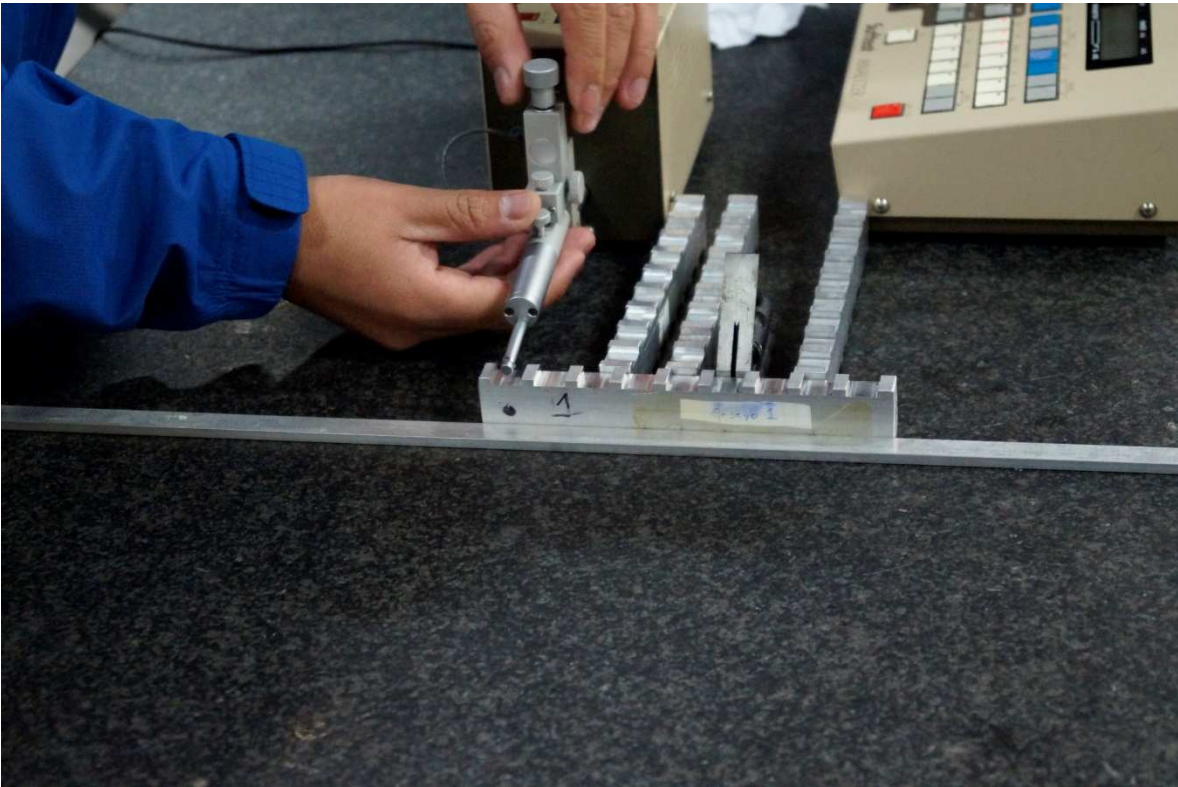
Figura 13. Ajuste de la altura del dentador para adaptarse a la altura de las probetas Se colocó además una guía para las probetas para garantizar la perpendicularidad entre la probeta y el rugosímetro como lo ilustra la figura 14.
