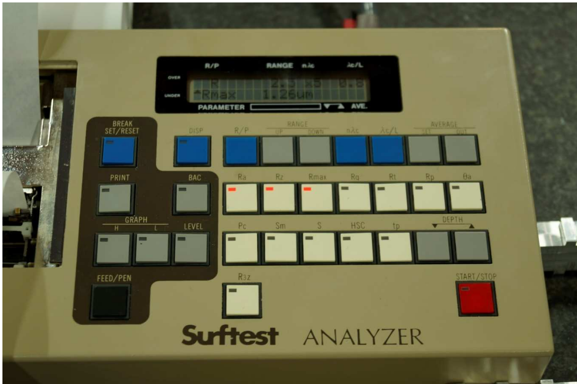
Figura 3.16 Vista de los parámetros utilizados en el rugosímetro.
