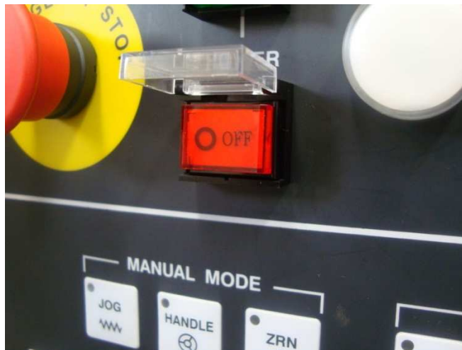
Figura 10. Ubicación y disposición del botón de apagado.
