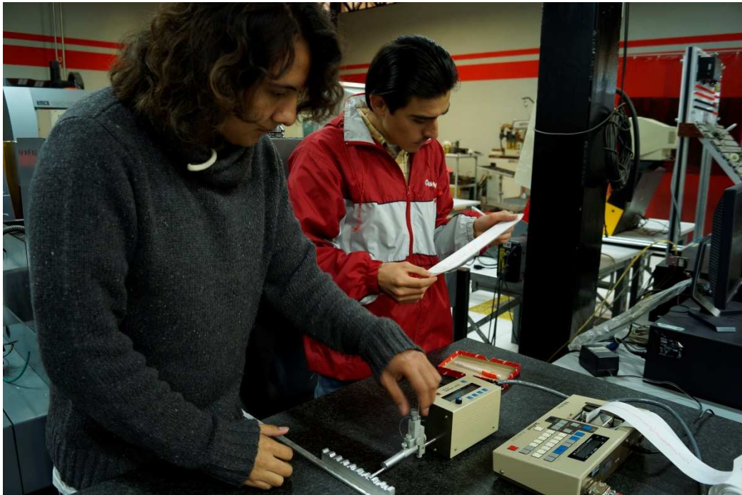
Figura 14. Uso de la guía para medir la rugosidad en las ranuras de las probetas
