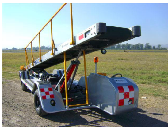
Imagen 56. Banda Conveyer o Rampa Eléctrica
