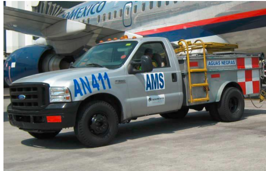
Imagen 53. Camioneta de Aguas Negras
