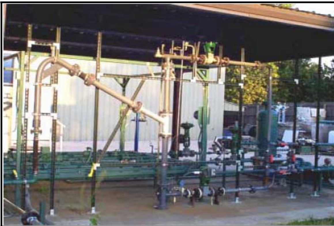
Fig. 5.1 Separador CCGL fabricado en la U. Tulsa. Sección de Prueba.
