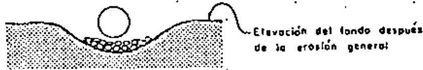
a) Colocación incorrecto. La erosión se produce si solo se coloca el pedraplén en la parte superior
