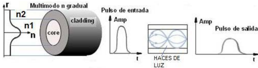
Figura 3.21 Índices de refracción y pulsos de entrada y salida en la fibra óptica Multimodo de índice gradual
