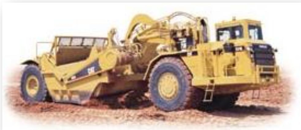
**Img19.** Motoescrepa. Máquina para cortar, mover y transportar grandes volúmenes de material.
