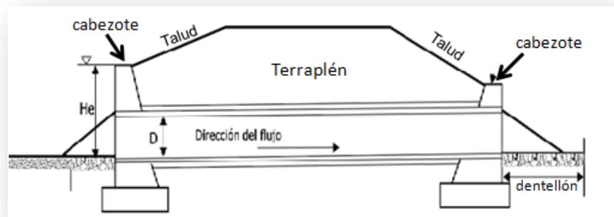
**Img 117.** Perfil de alcantarilla tubular.
