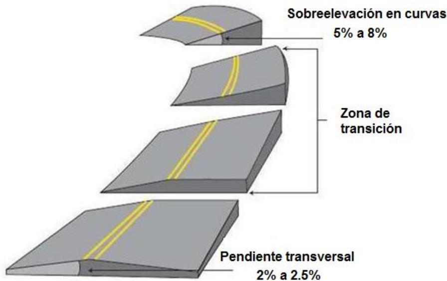
**Img. 106.** Cortes transversales donde se aprecian las pendientes que se le debe dar al *bombeo*.
