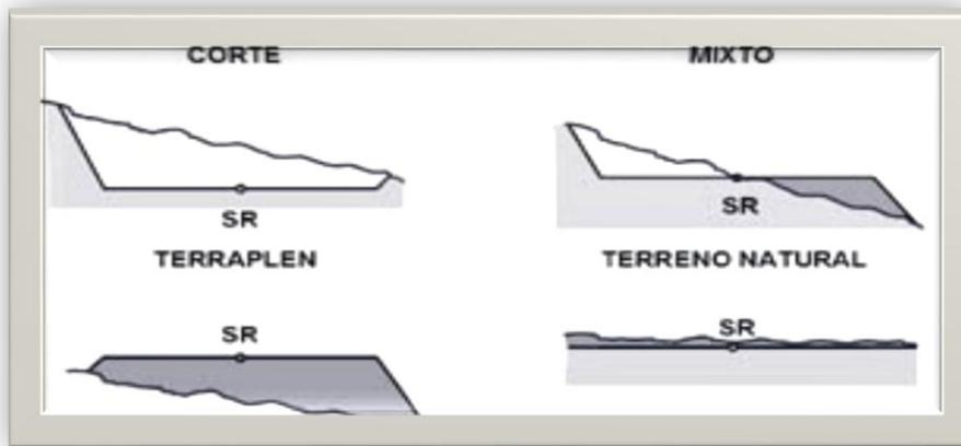
**Img 17.** Imagen que nos muestra los tipos de *sección transversal*. SR = Subrasante.
