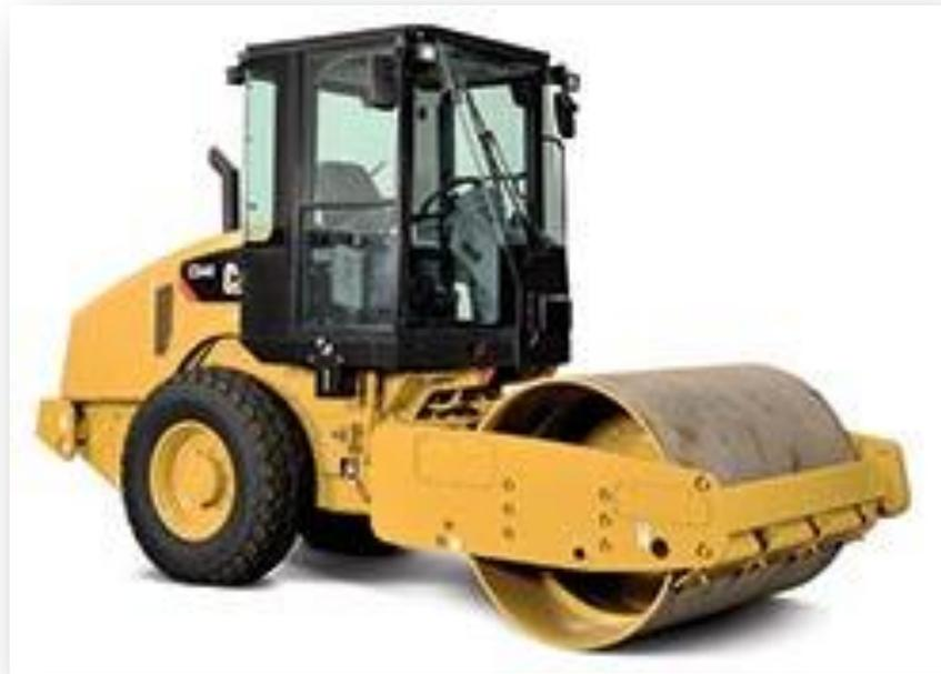
**Img. 28.** Compactador monocilíndrico.
