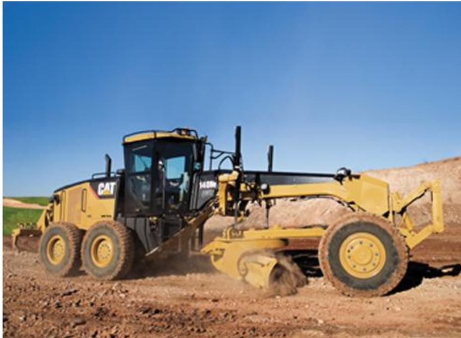
Img 23. Motoconformadora.
