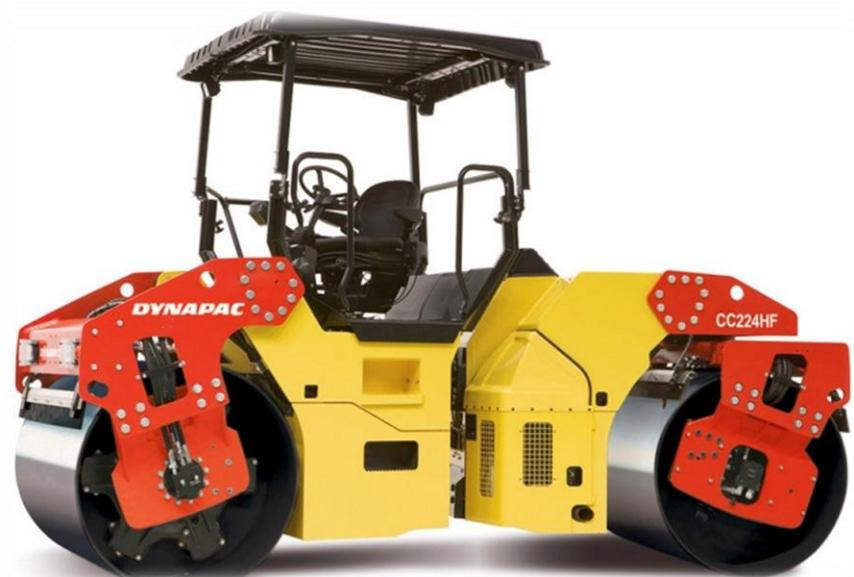
**Img 29.** Compactador bicilíndrico.
