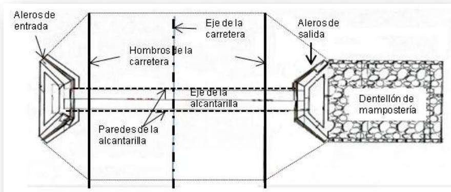
**Img 116.** Planta de alcantarilla.
