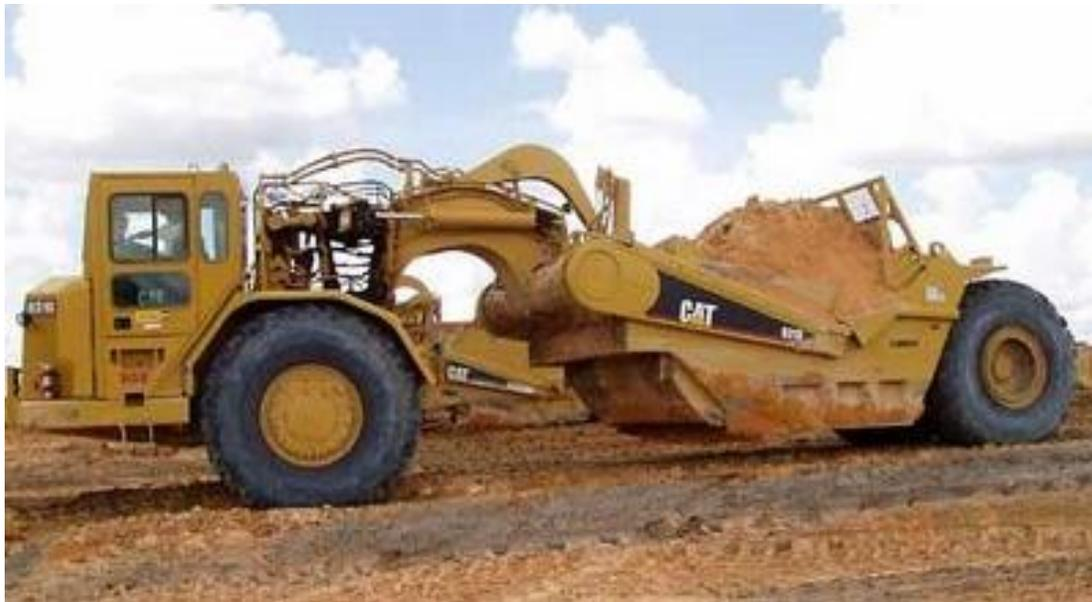
**Img. 42.** Material transportado del préstamo a la obra por medio de una motoescrepa.
