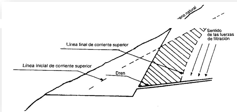
**Img 148.** Forma de captación de un dren transversal de talud.
