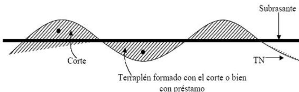
**Img 15.** Esquema que muestra el material de corte o en terraplén, con relación a la subrasante. TN = terreno natural.
