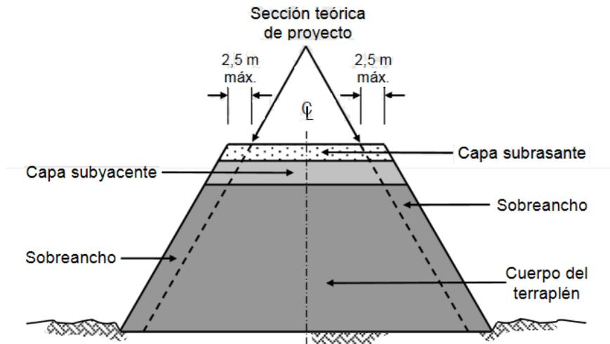
FIGURA 1.- Sección transversal de un terraplén
