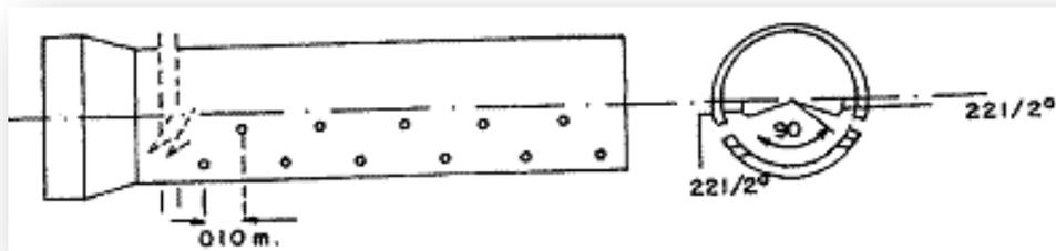
**Img 146.** Disposición de las perforaciones en tuberías de subdrenaje.
