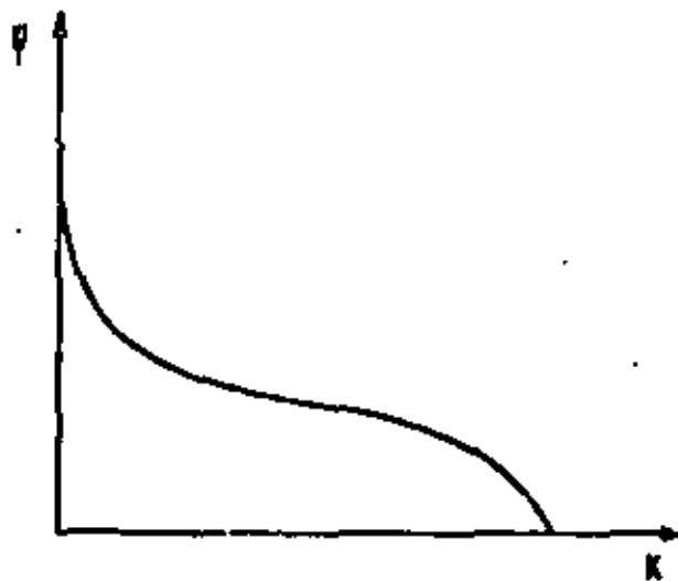
FIGURA 10.- EN EL FLUJO NO SATURADO LA CONDUCTIVIDAD HIDRAULICA ( K ) DECEDE CON LA TENSION DE HUMEDAD DEL SUELO ( \psi )
