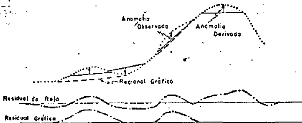
FIG. 6.- Perfil de la Curva Hipotética de Gravedad con Anomalías Residual Gráfico y de Reja.
