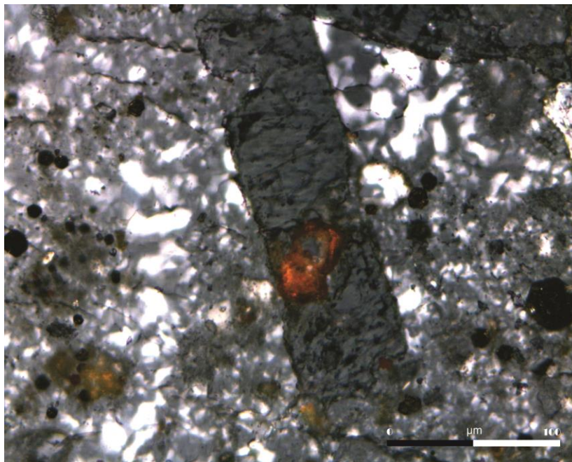
Figura 4.3.- Microfotografía de laminada delgada, donde se observan pseudomorfos de hematita-goethita dentro de un cristal de barita. Luz reflejada a 10x y con nicoles cruzados.
