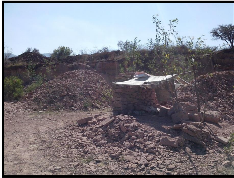
Figura 4. 10 Tiendas de trabajo donde se labra la roca junto al banco de la cantera.
