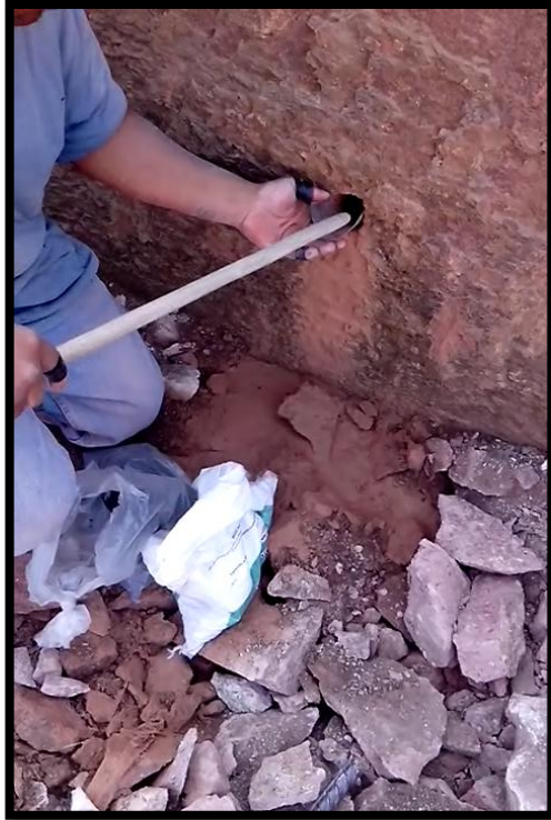
Figura 4. 4 Compresión con atacador de madera.
