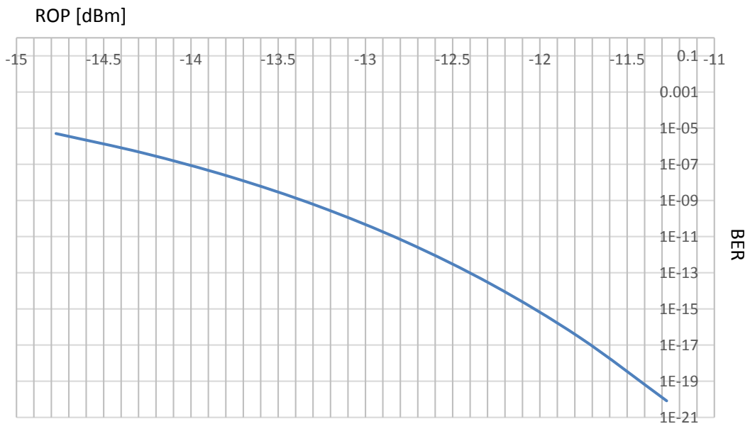
Figura 4.10 Curva ROP vs. BER de receptor óptico para arquitectura de transceptor 16x25 con espaciamento intercanal de 800 [GHz] para el cálculo de la sensibilidad.
