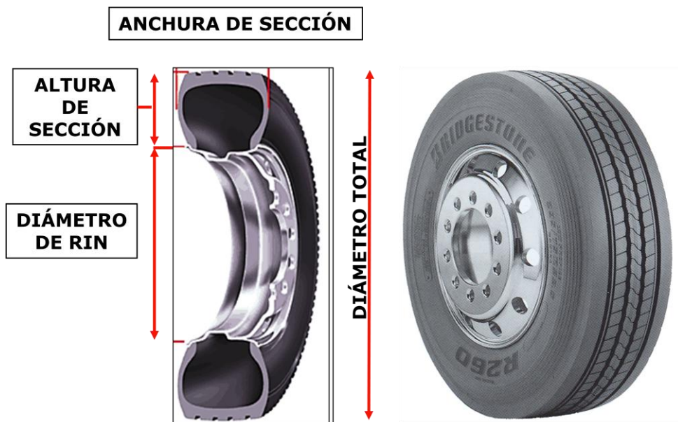
Ilustración 3 Dimensiones de una Llanta
