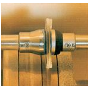
Ilustración 9. Proceso de Biselado de lente óptico, Fuente: Essilor Inc.
