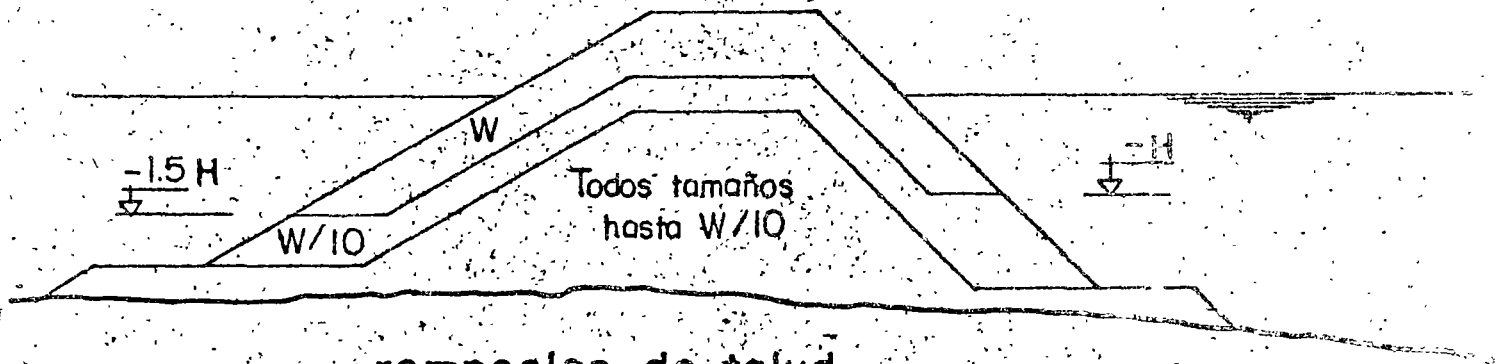
rompeolas de talud.
