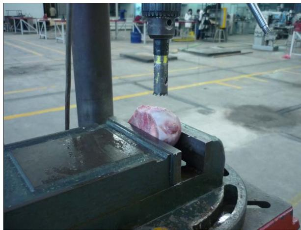
Figura 3.4 Obtención de la probeta para análisis microestructural.
