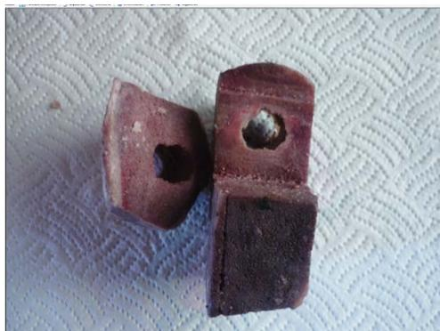
Figura 3.5 Cortes en trocánter mayor y cabeza femoral para la obtención de probetas.
