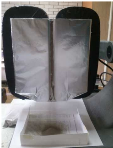
Figura 3.10b. Utilizando el equipo Frantz, se observa la fase magnética retenida por el imán y una fase no magnética que cae en la parte inferior.
